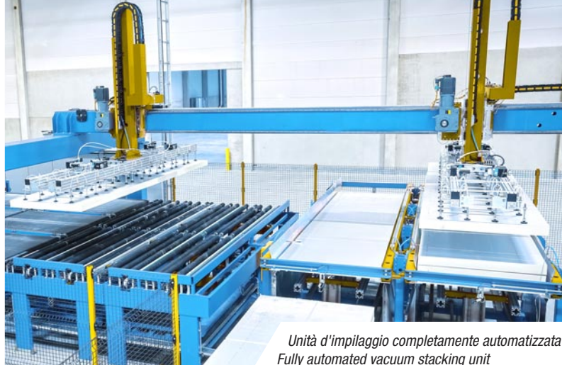
Manipolazione pannelli con robot industriale Stack-handling by industrial robot
